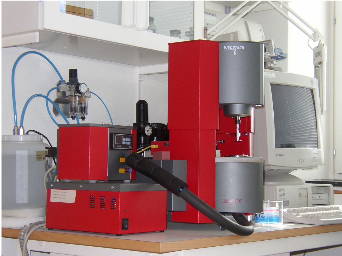
Bild 4.2-2 DSR(Dynamic Shear Rheometer)-utrustning för reologiska bitumenstudier. Foto: Nynäs AB
